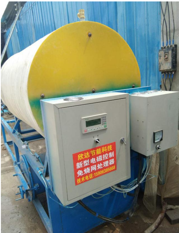
电磁烧网机（滤网加热分解成滤渣）
